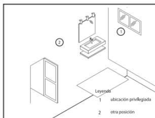
En el caso de instalar un aparato a proximidad de una puerta, el detensor de ventanas abiertas podría sufrir perturbaciones, por la corriente de aire ocasionado por la apertura de dicha puerta.
