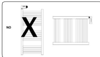
**Regole specifiche per bagni secondo il regolamento elettrotecnico per la bassa tensione ITC-BT-27 del settembre 2003.**
