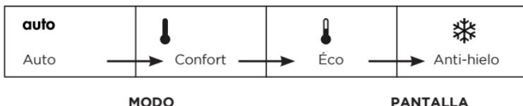
**Auto:** En el modo Automático, el aparato asegura automáticamente el paso a Confort o Eco según la programación establecida.
